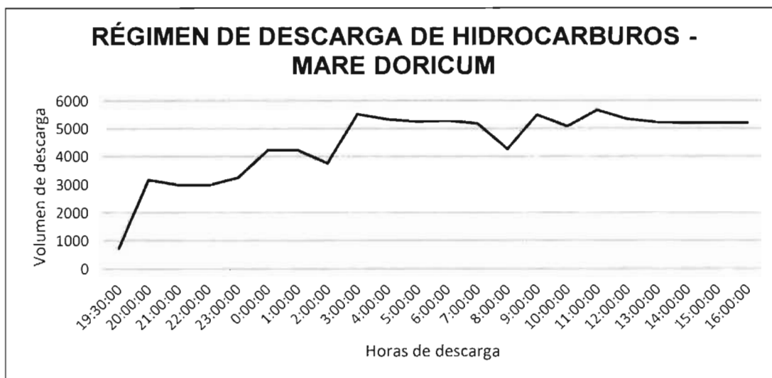
Figura 23. Régimen de descarga de hidrocarburos del BT Mare Doricum en m 3 /h
