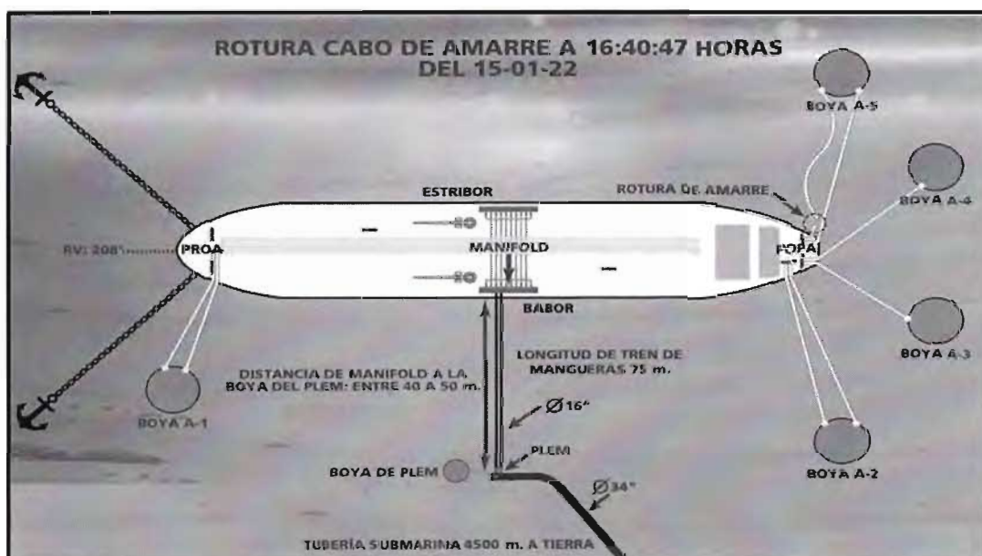
Figura 13. Esquema de rotura de amarre del 15 de enero a las 16:40:47 horas
